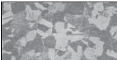
El mismo acero, luego de ser deformado en frío por estirado, con una reducción de sección del 25%.
