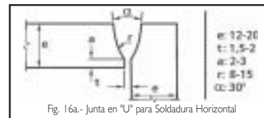
Fig. 16a.- Junta en "U" para Soldadura Horizontal
