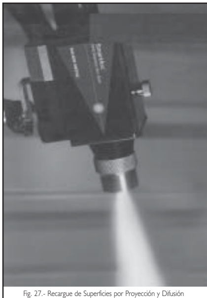
Fig. 27.- Recargue de Superficies por Proyección y Difusión
