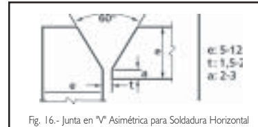
Fig. 16.- Junta en "V" Asimétrica para Soldadura Horizontal
