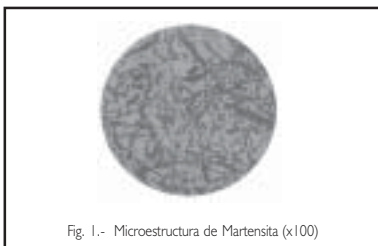
Fig. 1.- Microestructura de Martensita (x100)
