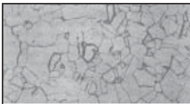
Microestructura de un acero austenítico al Mn, calentado a 1050°C y luego enfriado en agua.
